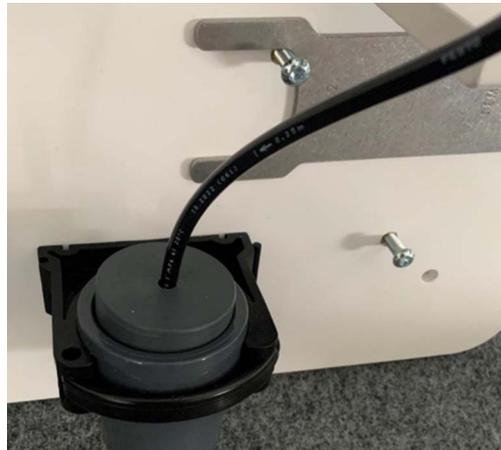
*Bild 3-5 Ablauftrichter mit montiertem Ablaufschlauch*
