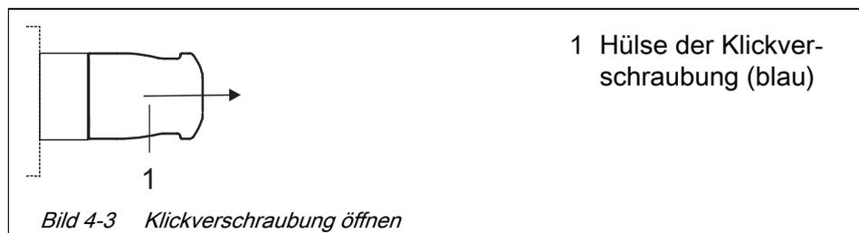
2. Schlauch 26 mm tief in die Hülse (1) der Klickverschraubung stecken. Bei zu geringer Einstecktiefe ist die Verbindung nicht dicht.
